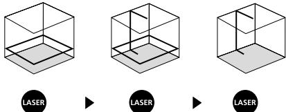
! Zum horizontalen und vertikalen Nivellieren muss die Transportsicherung gelöst sein. Sobald sich das Gerät außerhalb des automatischen Nivellierungsbereichs von  $3^\circ$  befindet, blinken die Laserlinien. Positionieren Sie das Gerät so, das es sich innerhalb des Nivellierungsbereichs befindet.
