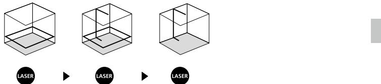
! Til horizontal og vertikal nivellering skal transportsikringen være løsnet. Så snart apparatet er uden for det automatiske nivelleringsområde på 3°, blinker laserlinjerne. Apparatet skal positioneres således, at det er inden for nivelleringsområdet.
