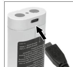
! L'accu ne doit être chargé **qu'à** l'aide du chargeur fourni et être utilisé exclusivement **avec ce** dispositif laser pour éviter tout risque de blessure et d'incendie.
