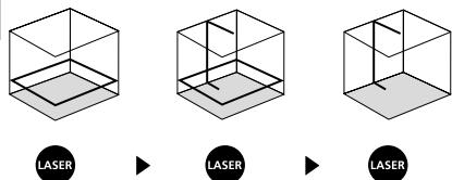
! Voor de horizontale en verticale nivellering moet de transportbeveiling gedeactiveerd zijn. Zodra het apparaat zich buiten het automatische nivelleerbereik van  $3^\circ$  bevindt, knipperen de laserlijnen. Positioneer het apparaat zodanig dat het zich binnen het nivelleerbereik bevindt.
