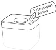
2 Entfernen Sie die obere Abdeckung und füllen Sie den Wassertank.
