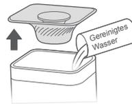
3 Entfernen Sie die obere Abdeckung, halten Sie den Wassertank mit beiden Händen fest und nehmen Sie ihn heraus. Stellen Sie den Wassertank unter den Wasserhahn, um Wasser hinzuzufügen.
