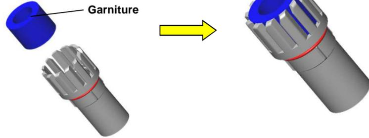
3. Monter le "gros" joint sur le corps (côté gorge sur la face du 6 pans)
