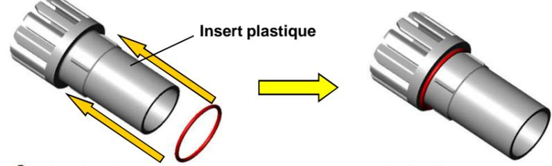
2. Insérer la garniture en butée dans l'insert plastique "côté lamelles"
