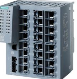
SCALANCE XC224 SCALANCE XC224 MANAGEABLE LAYER 2 IE-SWITCH; 16X 10/100 MBIT/S RJ45 PORTS; 1X CONSOLE PORT; DIAGNOSITICS-LED; REDUNDANT POWER SUPPLY; TEMP RANGE -40°C UP TO +70°C; MOUNTING WALL/ DINRAIL, S7 DINRAILL C-PLUG SLOT; REDUNDANCY FUNCTIONS; OFFICE FEATURES(RSTP,VLAN,...); PROFINET IO-DEVICE; ETHERNET/IP-CONFORMAL;
