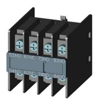
AUX.SWITCH BLOCK,FRONT,3NO+1NC, CURR.PATH: 1NO, 1NC, 1NO, 1NO, FOR CONTACTOR RELAYS, SZ S00, RING CABLE LUG CONNECTION 53 / 54,61 / 62,73 / 74,83 / 84
