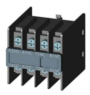
AUX.SWITCH BLOCK,FRONT,1NO+3NC, CURR.PATH: 1NO, 1NC, 1NC, 1NC, FOR CONTACTOR RELAYS, SZ S00, RING CABLE LUG CONNECTION 53 / 54,61 / 62,71 / 72,81 / 82
