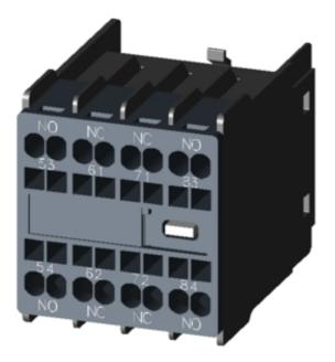
AUX.SWITCH BLOCK,FRONT,2NO+2NC, CURR.PATH: 1NO, 1NC, 1NC, 1NO, FOR CONTACTOR RELAYS, SZ S00, SPRING-LOADED TERMINAL 53 / 54,61 / 62,71 /72,83 / 84
