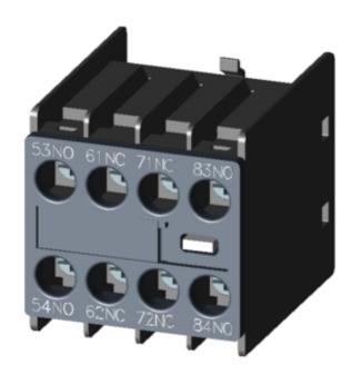
AUX.SWITCH BLOCK,FRONT,2NO+2NC, CURR.PATH: 1NO, 1NC, 1NC, 1NO, FOR CONTACTOR RELAYS, SZ S00, SCREW TERMINAL 53 / 54,61 / 62,71 / 72,83 / 84
