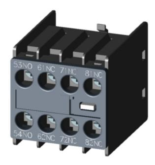
AUX.SWITCH BLOCK,FRONT,1NO+3NC, CURR.PATH: 1NO, 1NC, 1NC, 1NC, FOR CONTACTOR RELAYS, SZ S00, SCREW TERMINAL 53 / 54,61 / 62,71 / 72,81 / 82
