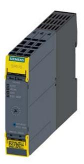
MOTORSTARTER SIRIUS 3RM1 REVERSING STARTER SAFETY 500 V; 0.4-2.0 A; 24 V DC CONTROL CIRCUIT PUSH-IN MAIN CIRCUIT SCREW TERMINAL
