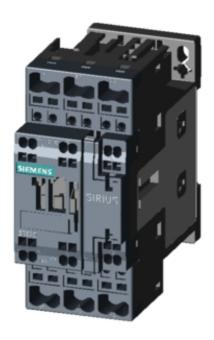
CONTACTOR, AC-3, 7.5KW/400V, 1NO+1NC, AC 220V 50HZ, 240V 60HZ 3-POLE, SZ SO SPRING-LOADED TERMINAL
