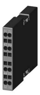
LATERAL AUX.SWITCH BLOCK,SIDE, 1NO+1NC, CURR.PATH: 1NC, 1NO, FOR MOTOR CONTACTORS, SZ S0, SPRING-LOADED TERMINAL R: 31/32, 43/44 L: 51/52, 63/64
