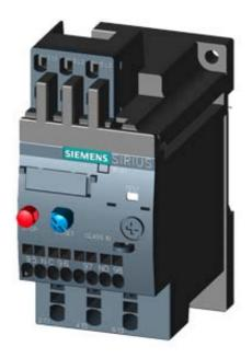
OVERLOAD RELAY 2.8...4.0 A FOR MOTOR PROTECTION SZ S00, CLASS 10, STAND-ALONE INSTALLATION MAIN CIRCUIT: SPRING TERMINAL AUX. CIRCUIT: SPRING TERMINAL MANUAL-AUTOMATIC-RESET
