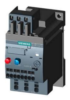
OVERLOAD RELAY 0.90...1.25 A FOR MOTOR PROTECTION SZ S00, CLASS 10, STAND-ALONE INSTALLATION MAIN CIRCUIT: SPRING TERMINAL AUX. CIRCUIT: SPRING TERMINAL MANUAL-AUTOMATIC-RESET
