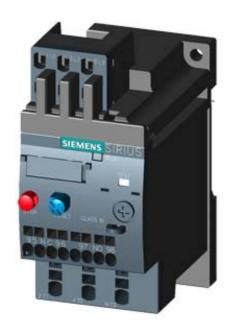
OVERLOAD RELAY 0.28...0.40 A FOR MOTOR PROTECTION SZ S00, CLASS 10, STAND-ALONE INSTALLATION MAIN CIRCUIT: SPRING TERMINAL AUX. CIRCUIT: SPRING TERMINAL MANUAL-AUTOMATIC-RESET
