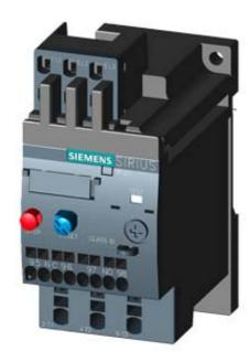
OVERLOAD RELAY 0.35...0.50 A FOR MOTOR PROTECTION SZ S00, CLASS 10, STAND-ALONE INSTALLATION MAIN CIRCUIT: SPRING TERMINAL AUX. CIRCUIT: SPRING TERMINAL MANUAL-AUTOMATIC-RESET
