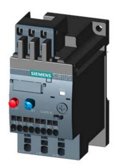
OVERLOAD RELAY 0.18...0.25 A FOR MOTOR PROTECTION SZ S00, CLASS 10, STAND-ALONE INSTALLATION MAIN CIRCUIT: SPRING TERMINAL AUX. CIRCUIT: SPRING TERMINAL MANUAL-AUTOMATIC-RESET
