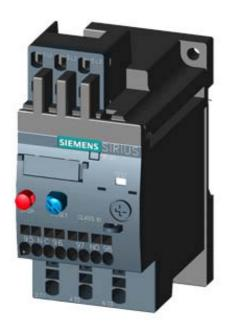
OVERLOAD RELAY 0.14...0.20 A FOR MOTOR PROTECTION SZ S00, CLASS 10, STAND-ALONE INSTALLATION MAIN CIRCUIT: SPRING TERMINAL AUX. CIRCUIT: SPRING TERMINAL MANUAL-AUTOMATIC-RESET
