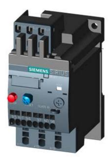
OVERLOAD RELAY 0.45...0.63 A FOR MOTOR PROTECTION SZ S00, CLASS 10, STAND-ALONE INSTALLATION MAIN CIRCUIT: SPRING TERMINAL AUX. CIRCUIT: SPRING TERMINAL MANUAL-AUTOMATIC-RESET
