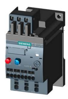
OVERLOAD RELAY 0.70...1.0 A FOR MOTOR PROTECTION SZ S00, CLASS 10, STAND-ALONE INSTALLATION MAIN CIRCUIT: SPRING TERMINAL AUX. CIRCUIT: SPRING TERMINAL MANUAL-AUTOMATIC-RESET
