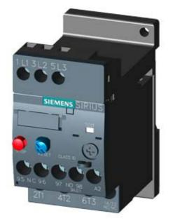
OVERLOAD RELAY 2.8...4.0 A FOR MOTOR PROTECTION SZ S00, CLASS 10, STAND-ALONE INSTALLATION MAIN CIRCUIT: SCREW TERMINAL AUX. CIRCUIT: SCREW TERMINAL MANUAL-AUTOMATIC-RESET
