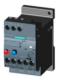
OVERLOAD RELAY 2.2...3.2 A FOR MOTOR PROTECTION SZ S00, CLASS 10, STAND-ALONE INSTALLATION MAIN CIRCUIT: SCREW TERMINAL AUX. CIRCUIT: SCREW TERMINAL MANUAL-AUTOMATIC-RESET
