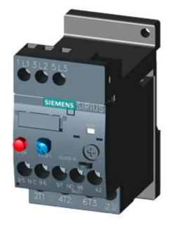
OVERLOAD RELAY 0.55...0.80 A FOR MOTOR PROTECTION SZ S00, CLASS 10, STAND-ALONE INSTALLATION MAIN CIRCUIT: SCREW TERMINAL AUX. CIRCUIT: SCREW TERMINAL MANUAL-AUTOMATIC-RESET
