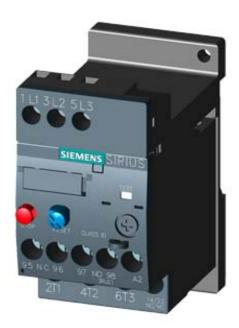
OVERLOAD RELAY 0.18...0.25 A FOR MOTOR PROTECTION SZ S00, CLASS 10, STAND-ALONE INSTALLATION MAIN CIRCUIT: SCREW TERMINAL AUX. CIRCUIT: SCREW TERMINAL MANUAL-AUTOMATIC-RESET
