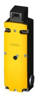
SAFETY POSITION SWITCHES WITH SOLENOID INTERLOCKING LOCK. FORCE 2600N,5 APPR. DIR. METAL HOUSING,3X(M20X1.5) SPRING-LOCKED, AUXILIARY RELEASE ON FRONT MAGNET VOLTAGE 230V AC,
