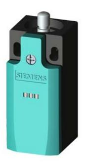
SIRIUS POSITION SWITCH; PLASTIC HOUSING ACC. TO EN50047, 31MM DEVICE CONNECTION 1X(M20X1.5); 1NO/2NC SNAP-ACTION CONTACTS TEFLON PLUNGER W. 2 LEDS YELLOW/GREEN, 24V DC
