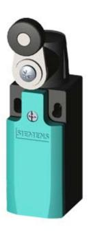
SIRIUS POSITION SWITCH; PLASTIC HOUSING ACC. TO EN50047, 31MM DEVICE CONNECTION 1X (M20X1.5); 1NO/2NC SNAP-ACTION CONTACTS ROLLER LEVER, 21MM LONG RIGHT/LEFT SIDE ADJUSTABLE W. PLASTIC ROLLER 19MM
