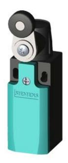
SIRIUS POSITION SWITCH; PLASTIC HOUSING ACC. TO EN50047, 31MM DEVICE CONNECTION 1X (M20X1.5); 1NO/2NC SLOW-ACTION CONTACTS ROLLER LEVER, 21MM LONG RIGHT/LEFT SIDE ADJUSTABLE W. PLASTIC ROLLER 19MM
