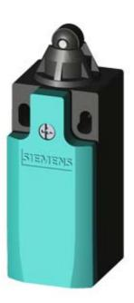
SIRIUS POSITION SWITCH; PLASTIC HOUSING ACC. TO EN50047, 31MM DEVICE CONNECTION 1X(M20X1.5); 1NO/2NC SLOW-ACTION CONTACTS ROLLER PLUNGER W. PLASTIC ROLLER 10MM
