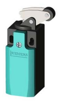
SIRIUS POSITION SWITCH; PLASTIC HOUSING ACC. TO EN50047, 31MM DEVICE CONNECTION 1X(M20X1.5); 1NO/1NC SNAP-ACTION CONTACTS INTEGRATED (NOT REPLACEABLE) ANGULAR ROLLER LEVER W. PLASTIC ROLLER 13MM
