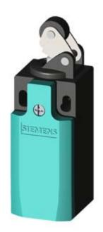
SIRIUS POSITION SWITCH PLASTIC HOUSING ACC. TO EN50047, 31MM DEVICE CONNECTION 1X(M20X1.5); 1NO/1NC SLOW-ACTION CONTACTS ROLLER LEVER W. PLASTIC ROLLER 13MM
