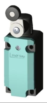
SIRIUS POSITION SWITCH METAL ENCLOSURE 40MM TO EN50041 DEVICE CONNECTION 1X (M20X1.5) 1NO/ 2NC SNAP-ACTION CONTACTS ROTARY ACTUATOR RIGHT/LEFT ADJUSTABLE, METAL LEVER 27MM LONG AND PLASTIC ROLLER 19MM
