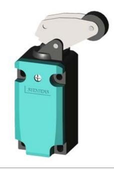
SIRIUS POSITION SWITCH METAL ENCLOSURE 40MM TO EN50041 DEVICE CONNECTION 1X (M20X1.5) 1NO/ 2NC SNAP-ACTION CONTACTS ANGULAR METAL ROLLER LEVER AND PLASTIC ROLLER 22MM
