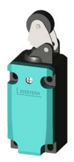
SIRIUS POSITION SWITCH METAL ENCLOSURE 40MM TO EN50041 DEVICE CONNECTION 1X (M20X1.5) 1NO/ 2NC SNAP-ACTION CONTACTS METAL ROLLER LEVER AND PLASTIC ROLLER 22MM
