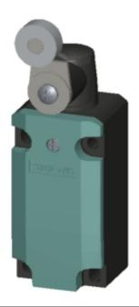
SIRIUS POSITION SWITCH METAL HOUSING 40MM, TO EN50041 DEVICE CONNECTION 1X (M20X1,5) 1NO/1NC SLOW-ACTION CONTACTS ROTARY ACTUATOR RIGHT/LEFT ADJUSTABLE, METAL LEVER 27MM LONG AND STAINL. STEEL ROLLER 19MM
