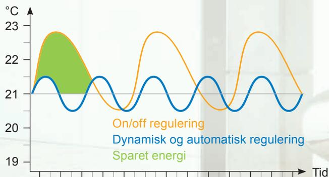
Mens en traditionel "on/off" regulering kun tager højde for varmebehovet kort tid om året, indregulerer Smatrix konstant energitilførslen i hele varmesæsonen afhængig af f.eks. inde og ude temperatur, solindfald og brugeradfærd. Det sparer energi og giver en jævn rumtemperatur og optimal komfort.
