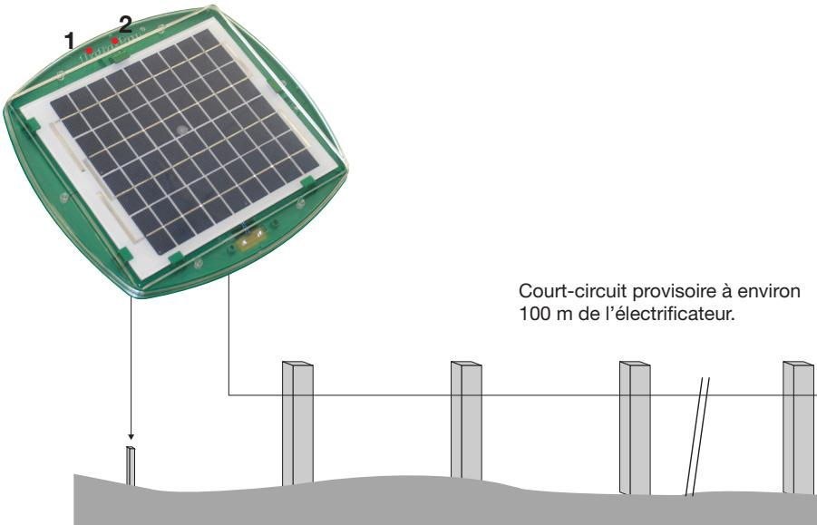
Court-circuit provisoire à environ 100 m de l'électrificateur.
