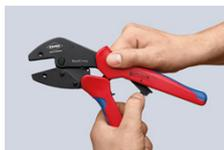
Skifteposition: Udklapning af service-grebet for parallel kæbestilling
