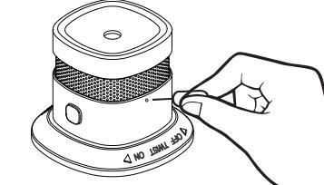
For at indstille røgalarmen til pairingstilstand, skal du trykke på netværksknappen og holde den nede i 3 sek.
