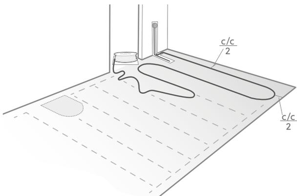
4. Sådan skal varmekablet lægges omkring gulv afløb og lignende. Gør plads til afløbsristen. OBS! Afstanden mellem gulv afløb og varmekabel skal være mindst 20 cm!
