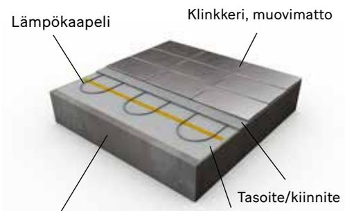
Olemassa oleva lattia (lastu-/kipsilevy tai betoni) mahd. eristyslevyllä Cable Board / Thermo Board. EPS-betonille/sementille tarvitaan pohjaverkko. Pohjaverkkoon asennettaessa kaapeli sijoitetaan verkon yläpuolelle.
