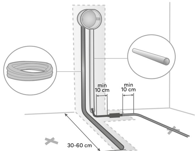
2a. Golvvärmekabeln har 2,5 meter anslutningskabel. Den förläggs i ett VP-rör/plaströr avsett för elmaterial.
