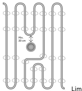
Kabeln får inte läggas under fast inredning som t.ex. toalettstolar. Toalettstolen kan med fördel fästas med silikon istället för att skruvas fast.
