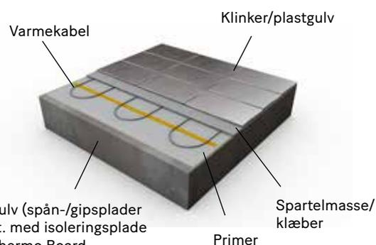
Eksisterende gulv (spån-/gipsplader eller beton) evt. med isoleringsplade Cable Board/Thermo Board.
