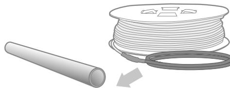
2b. Skjøten til tilkoblingskabel og endeavslutning må ikke plasseres i, eller i tilknytning til, ev. dusj/gulvsluk. Med suppleringssett skal begge kaldkablene trekkes opp og parallellkobles i termostaten.
