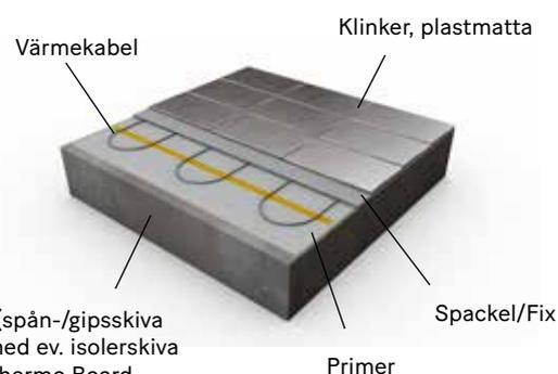
Befintligt golv (spån-/gipsskiva eller betong) med ev. isolerskiva Cable Board/Thermo Board.
