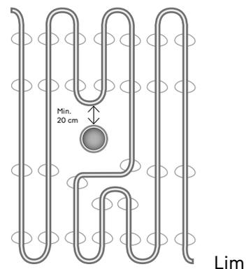
Kabelen må ikke legges under fast innredning, som f.eks. toalettskåler. Toalettskålen kan med fordel festes med silikon i stedet for å skrues fast.
