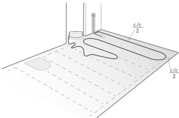
4. Das Heizkabel sollte wie folgt um Bodenabläufe und dergleichen verlegt werden. Platz für das Gitter zum Abfluss frei lassen. HINWEIS! Mindestens 20 cm Abstand zwischen Abfluss und Heizkabel!
