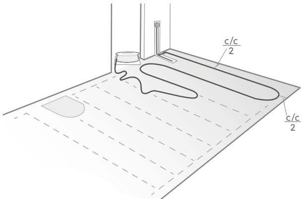
4. Näin lämpökaapeli tulee asentaa lattiakaivojen ja vastavien ympärille. Jätä kaivoon tilaa ritilälle. Huom.! Vähintään 20 cm etäisyys kaivon ja lämpökaapelin väliillä!
