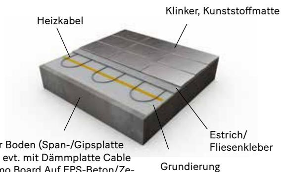
Vorhandener Boden (Span-/Gipsplatte oder Beton), evt. mit Dämmplatte Cable Board/Thermo Board Auf EPS-Beton/Zement sind Basisnetze erforderlich. Wenn ein Basisnetz zum Einsatz kommt, ist das Kabel darauf zu verlegen.
