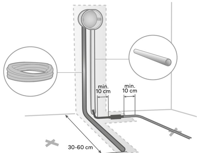
2a. Gulvvarmekablet har et tilslutningskabel på 2,5 meter. Det lægges i et VP-rør/plastrør beregnet til elinstallationer.
