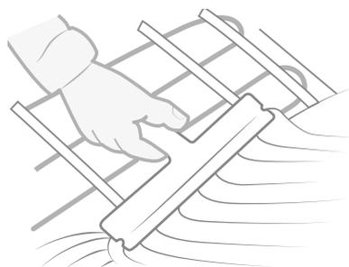
8. Om möjligt efter spackling, alternativt efter färdig golvbeläggning, utför en tredje isolations- och resistansmätning av värmekabeln. Fyll i testprotokollet eller använd Garantera i mobilen.
