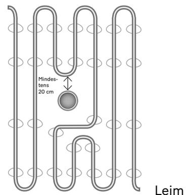
Das Kabel darf nicht unter fest verankerten Einrichtungen wie z. B. WC-Sitzen platziert werden. Es wäre vorteilhaft, WC-Sitze mit Silikon statt mit Schrauben zu befestigen.
