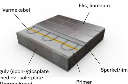
Eksisterende gulv (spon-/gipsplate eller betong) med ev. isolerplate Cable Board/Thermo Board. På EPS-betong/sement kreves armeringsnett. Ved bruk av armeringsnett skal kabelen legges på oversiden av armeringsnettet.
