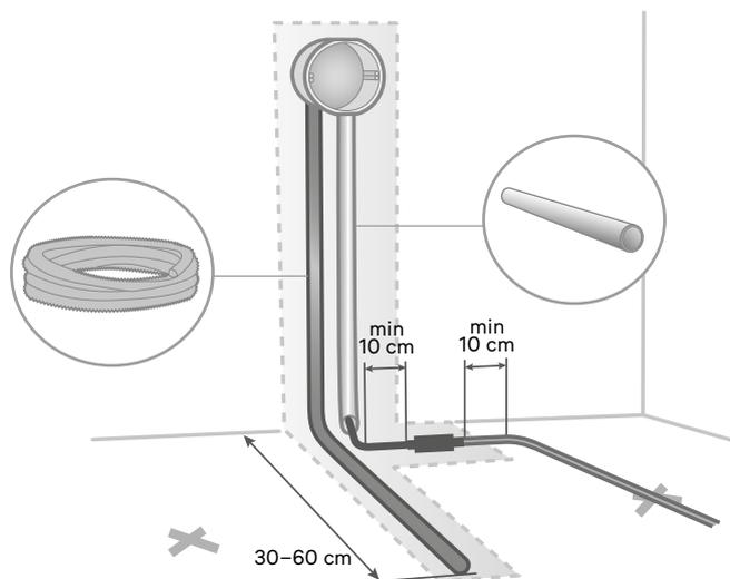
2a. Gulvvarmekabelen har 2,5 meter tilkoblingskabel. Den legges i et VP-rør/plastrør beregnet for elektrisk materiel.
