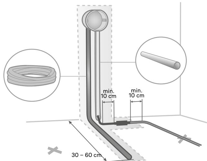
2a. Das Fußbodenheizungskabel hat ein Anschlusskabel von 2,5 Meter Länge. Es wird in einem Kunststoffrohr für Elektromaterialien verlegt.
