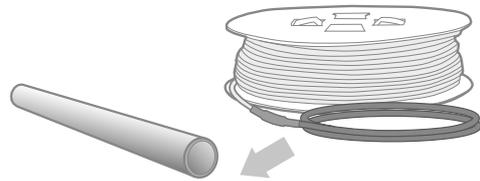
2b. Skarven till anslutningskabel och ändavslut får inte placeras inuti, eller i anslutning till ev. duschutrymme/ golvbrunn. Vid komplettering ska båda kalkablarna dras upp och parallellkopplas i termostaten.
