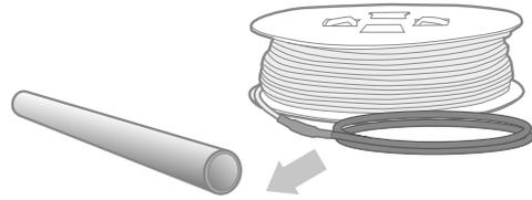
2b. Kytkentäkaapelin ja päädyn välistä liitosta ei saa sijoittaa sisälle tai mahdollisen suihkutilan/lattiakaivon yhteyteen. Täydennyssarjan yhteydessä molemmat kylmäkaapelit tulee vetää esiin ja kytkeä rinnan termostaattiin.
