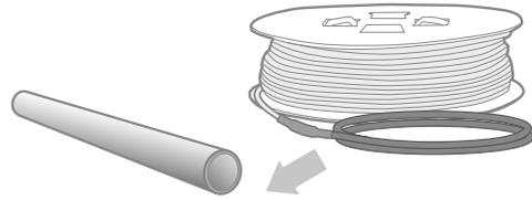
2b. Der Anschluss des Verbindungskabels und der Enden darf sich nicht im Inneren oder neben einem Duschaum/Bodenablauf befinden. *Beim Ergänzungsbausatz müssen beide Kaltkabel nach oben gezogen und parallel im Thermostat angeschlossen werden.*
