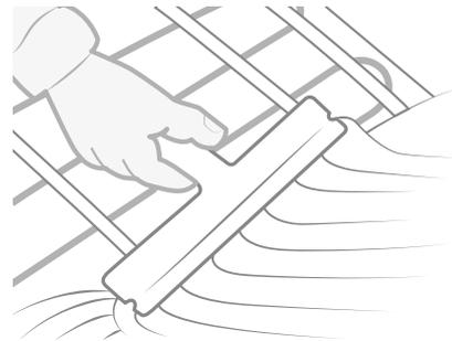
8. Wenn möglich ist nach den Spachtelarbeiten oder nach der Fertigstellung des Bodenbelags eine dritte Isolations- und Widerstandsmessung des Heizkabels durchzuführen. Die Werte ins Testprotokoll oder unter Garanterta im Handy eingeben.
