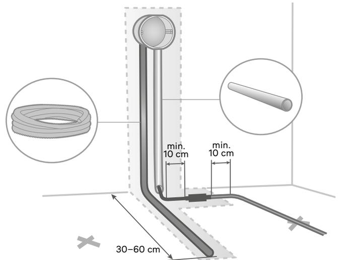
2a. Lattialämmityskaapelissa on 2,5 metrin kytkentäkaapeli. Se asennetaan sähkömateriaalille suunniteltuun VP-putkeen / muoviputkeen.
