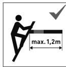
La position écarteur de mur est autorisée jusqu'à une distance maximale de 1 m 20.
