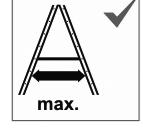
Używać drabiny tylko po całkowitym rozstawieniu i zabezpieczeniu otwarcia jej obu części.
