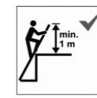
Scările pentru accesul la o înălțime mai mare trebuie extinse cu cel puțin 1 m peste punctul de rezemare și fixate, dacă este necesar.
