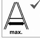
De ladder alleen met volledig gespreide en beveiligde opening van de twee ladderdelen gebruiken.
