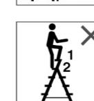
Ne pas utiliser les deux marches / échelons supérieurs d'une escabeau double sans plate-forme ni dispositif de retenue pour les mains / les genoux comme surface d'appui.
