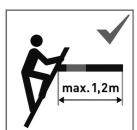
Žebřík lze použít v režimu offsetu do vzdálenosti max. 1,2 m.
