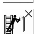
Evitați lucrările care cauzează încărcarea laterală a scărilor, de ex., forarea laterală prin materiale solide.
