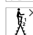
Använd inte de översta två stegen/stegpinnarna på en arbetsstege utan plattform och hållare för hand/knä som underlag för att stå på.
