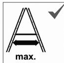
Rebrík používajte iba s úplne roztiahnutým a zabezpečeným otvorm oboch dielov rebríka.
