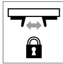
Avant utilisation, s'assurer que le mécanisme de verrouillage est en bon état et complètement verrouillé.
