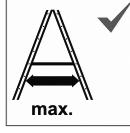
Utiliser exclusivement l'échelle avec les deux plans écartés au maximum.
