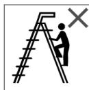
Ne pas monter sur l'échelle de ce côté.
