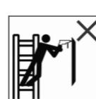
Evite los trabajos que originen una carga lateral en la escalera; p. ej., el taladrado lateral de materiales sólidos.
