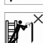
Werkzaamheden vermijden die een zijdelingse belasting bij ladders veroorzaken, zoals het van de zijkant boren door hard materiaal.
