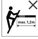
La pièce d'appui en mode écarteur de mur ne doit pas dépasser 1 m 20 de long.
