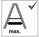
Žebřík se smí použít, jen pokud je úplně rozevřen a zajištěn. Použijte otevírání obou částí žebříku.
