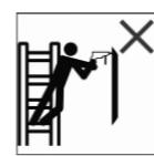
Unikać prac, które powodują boczne obciążenie drabiny, np. wiercenie z boku w twardym materiale.
