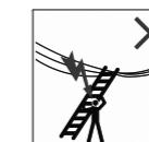
Determine todos los riesgos existentes en la zona de trabajo debido a dispositivos eléctricos; p. ej., líneas aéreas de alta tensión u otros dispositivos eléctricos al descubierto. No utilice la escalera cuando haya riesgos por descarga eléctrica.
