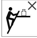
Stützteil im Offset-Modus nicht als Ablage verwenden.
