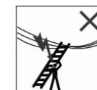
Alle potentiële risico's die door elektrische apparatuur in de werkomgeving ontstaan vaststellen, zoals bovengrondse hoogspanningsleidingen of andere toegankelijke elektrische apparatuur. De ladder niet gebruiken als er risico bestaat door elektrische stroom.
