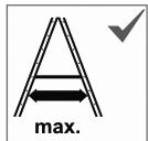
Stegen ska bara användas med båda stegdelarna fullständigt utställda och säkrade.
