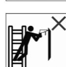
Vyhnete se činnostem, které způsobují boční zatížení na žebřících, např. boční vrtání do pevných materiálů.
