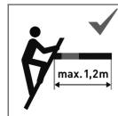
La escalera en modo offset se puede utilizar hasta una distancia máxima de 1,2 m.
