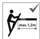
Tikkaita voidaan käyttää siirtymätilassa enintään 1,2 metrin etäisyydellä.
