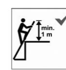
Pour accéder à un niveau supérieur, les échelles d'appui doivent dépasser leur point d'appui d'au moins 1 m et être sécurisées au besoin.
