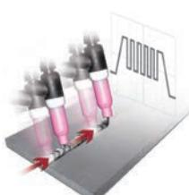
Ermöglicht eine Fokussierung und das Erzielen besserer Stabilität des Lichtbogens.
