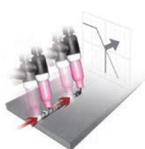
Ermöglicht das sofortige Erlöschen des Lichtbogens beim Downslope oder das Wiederzünden des Schweißvorgangs.
