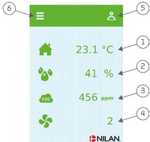
1. Viser den aktuelle rumtemperatur i huset, målt via udsugningsluften
