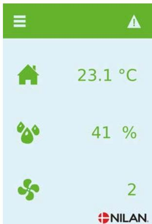
Sker der en fejl i ventilationsaggregatet, vil der enten komme en advarsel eller en alarm. Ikonet vises øverst til højre i menulinjen.
